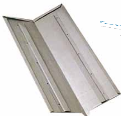
Limahoya (longitud: 1m) Fijación: 2 patas de zinc (2 por ml a cada lado)
